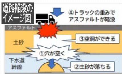
今回の事故は、広域な汚水が集まる「下水道幹線」が老朽化→空いた穴から土砂がくずれて水が流出、アスファルトと下水幹線の間で空洞が発生→道路や車両の重みで路面が陥没し、トラックが落下。
