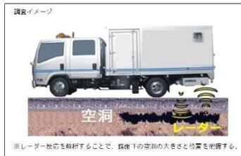
今回の緊急調査では、下水道幹線が通っている区道約12kmを対象に、車載型レーダーで地下1.5mまでの空洞の有無を点検。区内の下水道幹線は直径80cm～3.9mと多様で、都水道局が老朽化・耐震化ふくめ管理しています。
