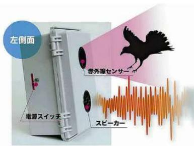
足立区では昨年、カラスが近づくと自動で、カラス同士が危険を知らせる鳴き声が流れる装置「クロウ(カラス)コントローラー」を、被害の大きいごみ集積所に試験的に設置。
