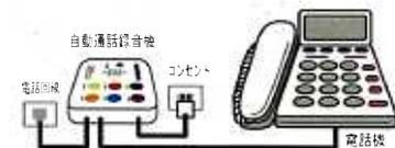
取付は録音機の電源をコンセントにさす。電話回線と録音機をケーブルでつなぐ。電話機と録音機をケーブルでつなぐ。
